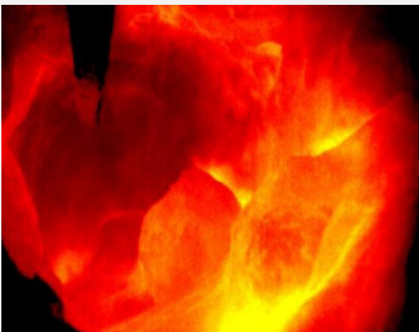
PYROINC 380LF热图像: 锌回收中清晰可见的凝块
